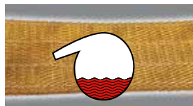
Повреждение в результате воздействия кислоты/щелочи
