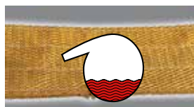
Повреждение в результате воздействия кислоты/щелочи
