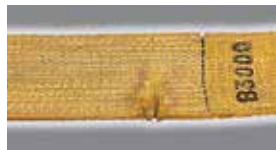
Повреждение основного шва
