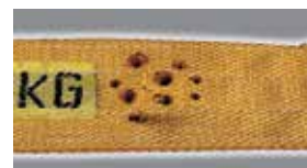
Повреждение в результате воздействия высокой температуры
